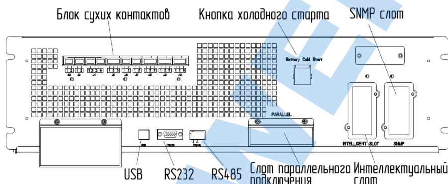
(a) Расположение сухих контактов и коммуникационных интерфейсов. MRX33-100/50X и MRX33-200/50X
